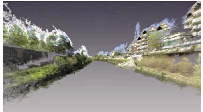
Abb. 7: 3D-Punktwolke eines Gewässerabschnittes auf der Lippe
