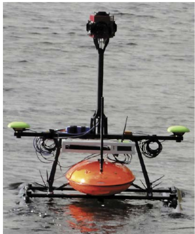
Abb. 5: RiverBoat mit Kameragestell und Doppel-GNSS-Antennen auf Einsatzfahrt
